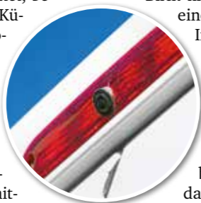
Die Kamera sitzt mittig in der Bremsleuchte.
