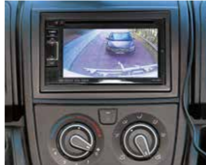
Modifikation 4: Die Rückfahrkamera hat Hestert selbst konzipiert und installiert.
