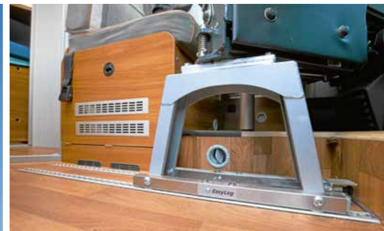
Modifikation 3: Der nachgerüstete Sitzplatz wird durch eine Alu-Platte verankert. Der Bodenbelag kaschiert das, man sieht nur die Schienen.
